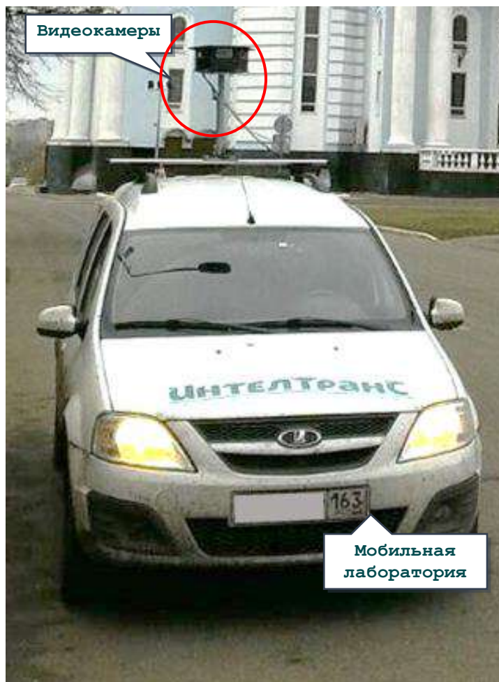
Рисунок. Мобильная лаборатория с видеокамерами и GPS- система
