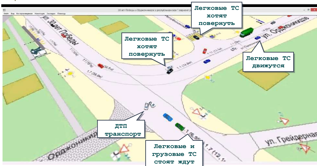
Рисунок. Статическая визуализация транспортных потоков (существующей интенсивности) на территории ул. Орджоникидзе х ул. 30 лет Победы, ул. Республиканская с учетом разных видов транспортных средств в ITSGIS (вариант проектирования №1*)
