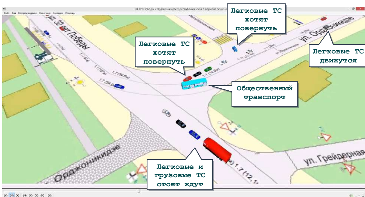
Рисунок. Статическая визуализация транспортных потоков (существующей интенсивности) на территории ул. Орджоникидзе х ул. 30 лет Победы, ул. Республиканская с учетом разных видов транспортных средств в ITSGIS (вариант проектирования №1*)
