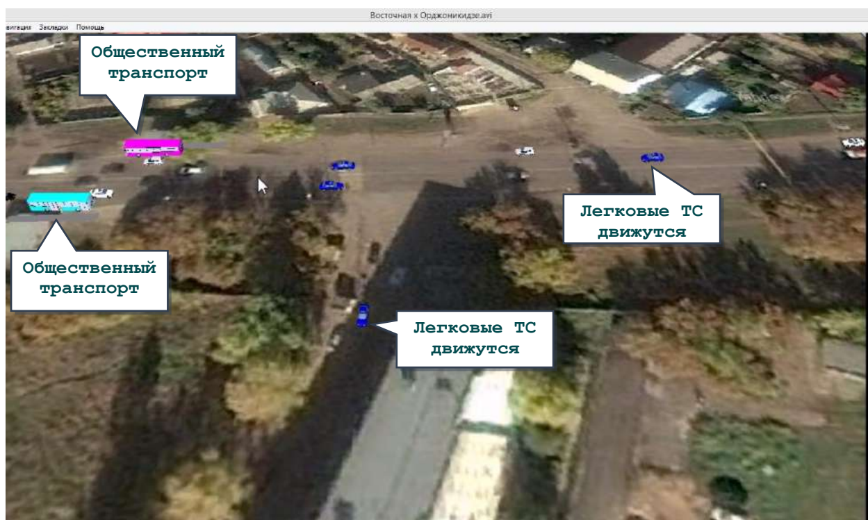
Рисунок. Статическая визуализация транспортных потоков (существующей интенсивности) на территории ул. Орджоникидзе х ул. Гарнизонная с учетом разных видов транспортных средств в VISSIM
