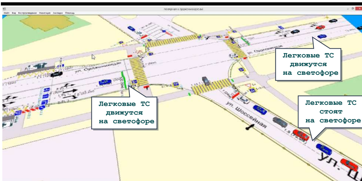
Рисунок. Статическая визуализация транспортных потоков (существующей интенсивности) на территории ул. Орджоникидзе х ул. Шосейная с учетом разных видов транспортных средств в ITSGIS
