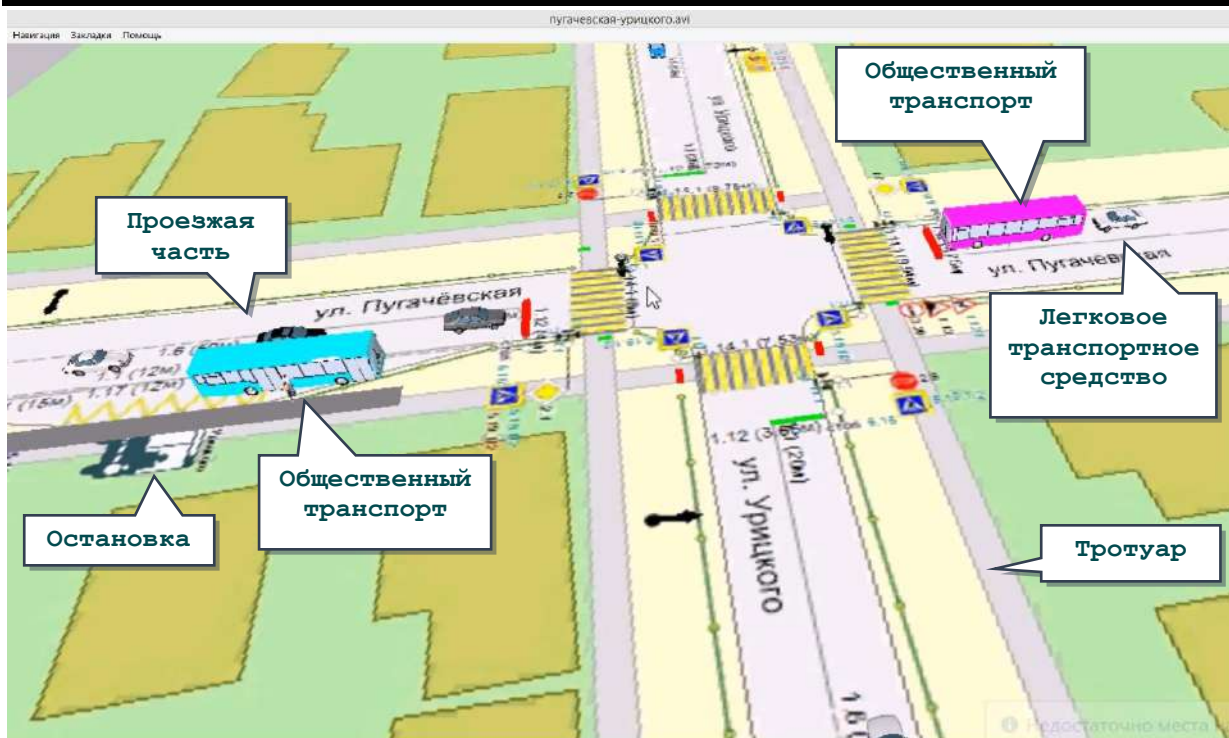
Рисунок. Статическая визуализация транспортных потоков (существующей интенсивности) на территории ул. Пугачевская с учетом разных видов транспортных средств
