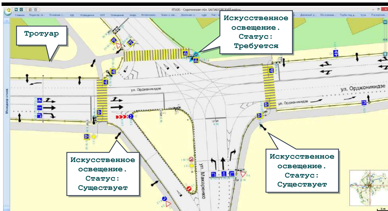
Рисунок. Дислокация искусственного освещения с визуализацией статусов: установлен, требуется, демонтировать
