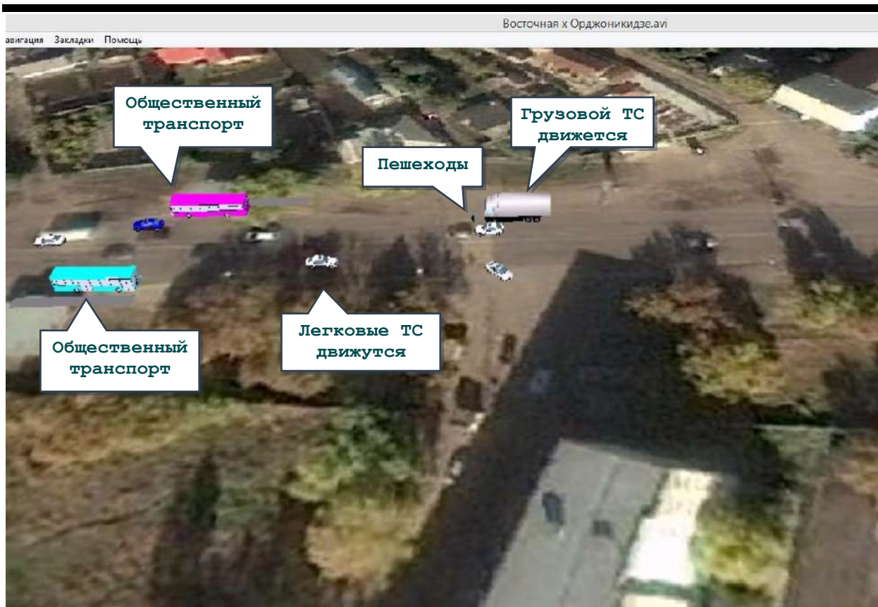
Рисунок. Статическая визуализация транспортных потоков (существующей интенсивности) на территории ул. Орджоникидзе х ул. Гарнизонная с учетом разных видов транспортных средств в VISSIM
